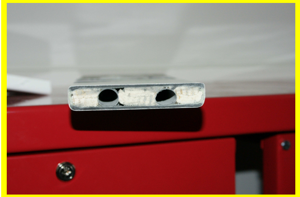
A mintegy 2 mm vastag szénzálás borítás elhelyezkedése a rugóstagon
