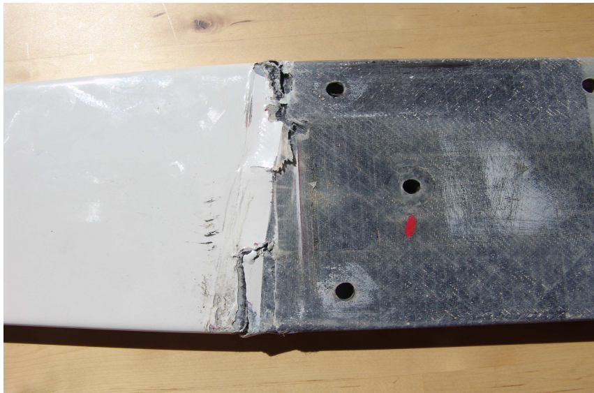
A törés képe a nyomott oldalon
