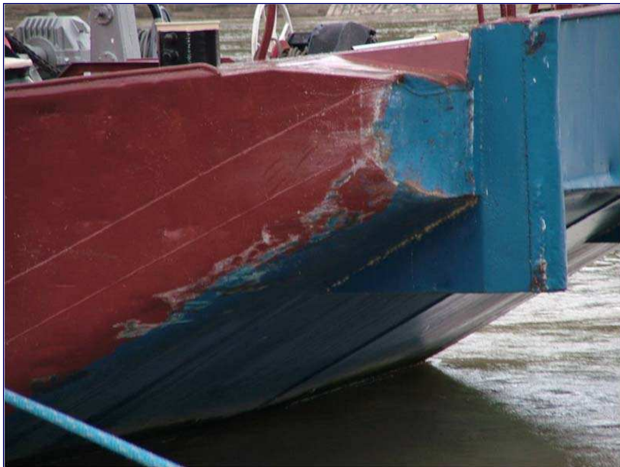
A Zsófia Főhercegné ms. sérülése a hajó orr részén.
