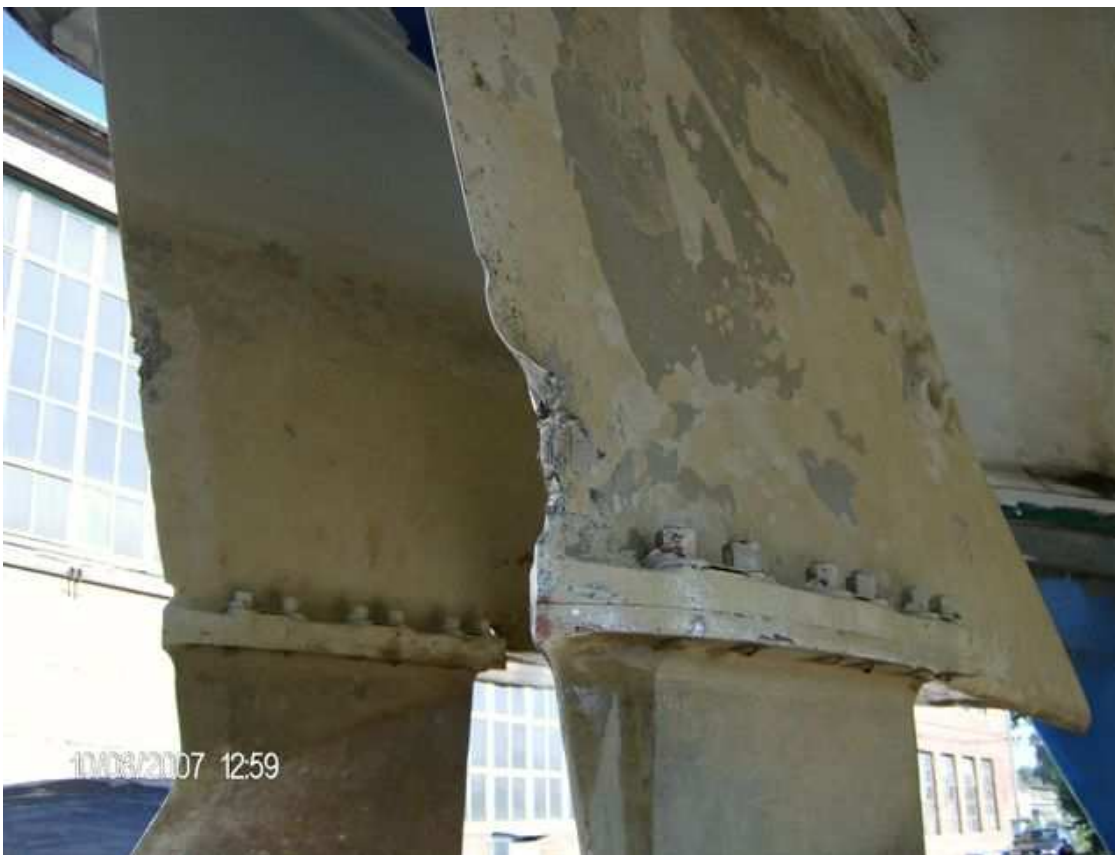
A szárnyashajó szárnytartó szerkezetén keletkezett sérülések.
