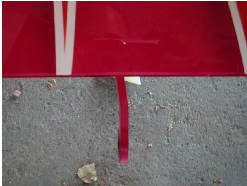
A középső bekötés deformált bakja.
