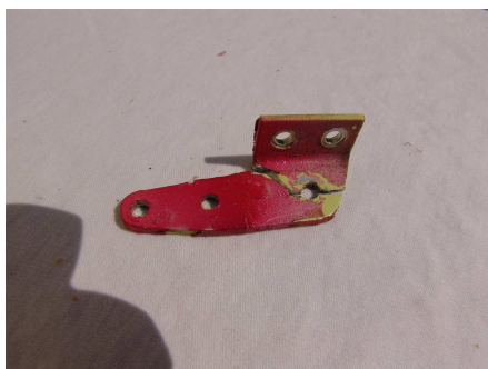
A jobb fül törése a forgáspontban
