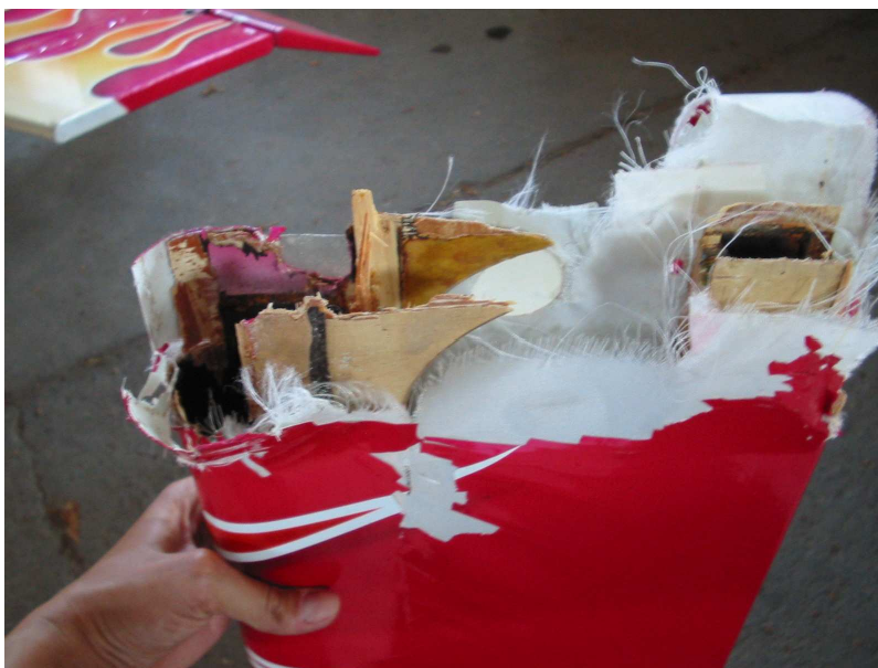
A csűrő-főtartó törésfelülete.
