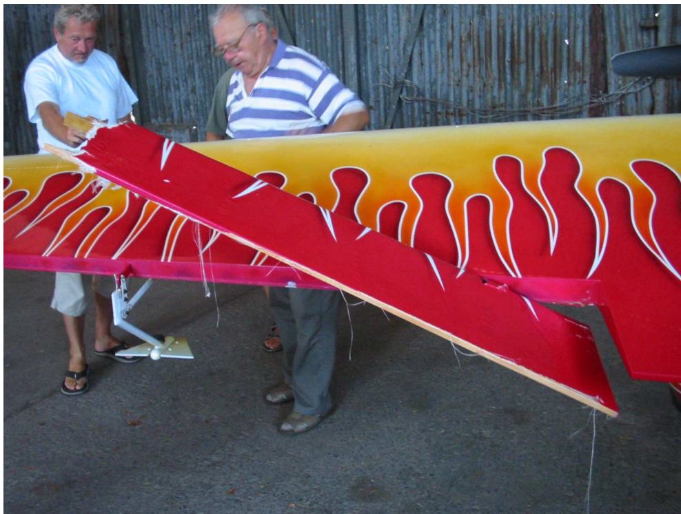
A csűrőmaradvány és a balszárny a középső bakkal.
