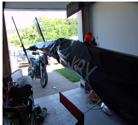
7. A törött faroktartó és stabilizátor
