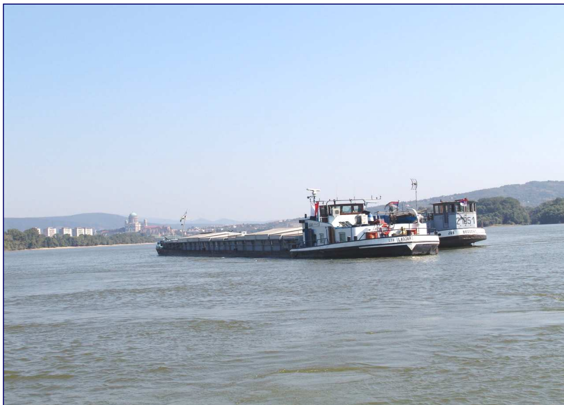
A zátonyon felakadt önjáró géphajó a hajó jobb oldalára csatolt uszályal, a képeken látható a vörös bója hiánya
