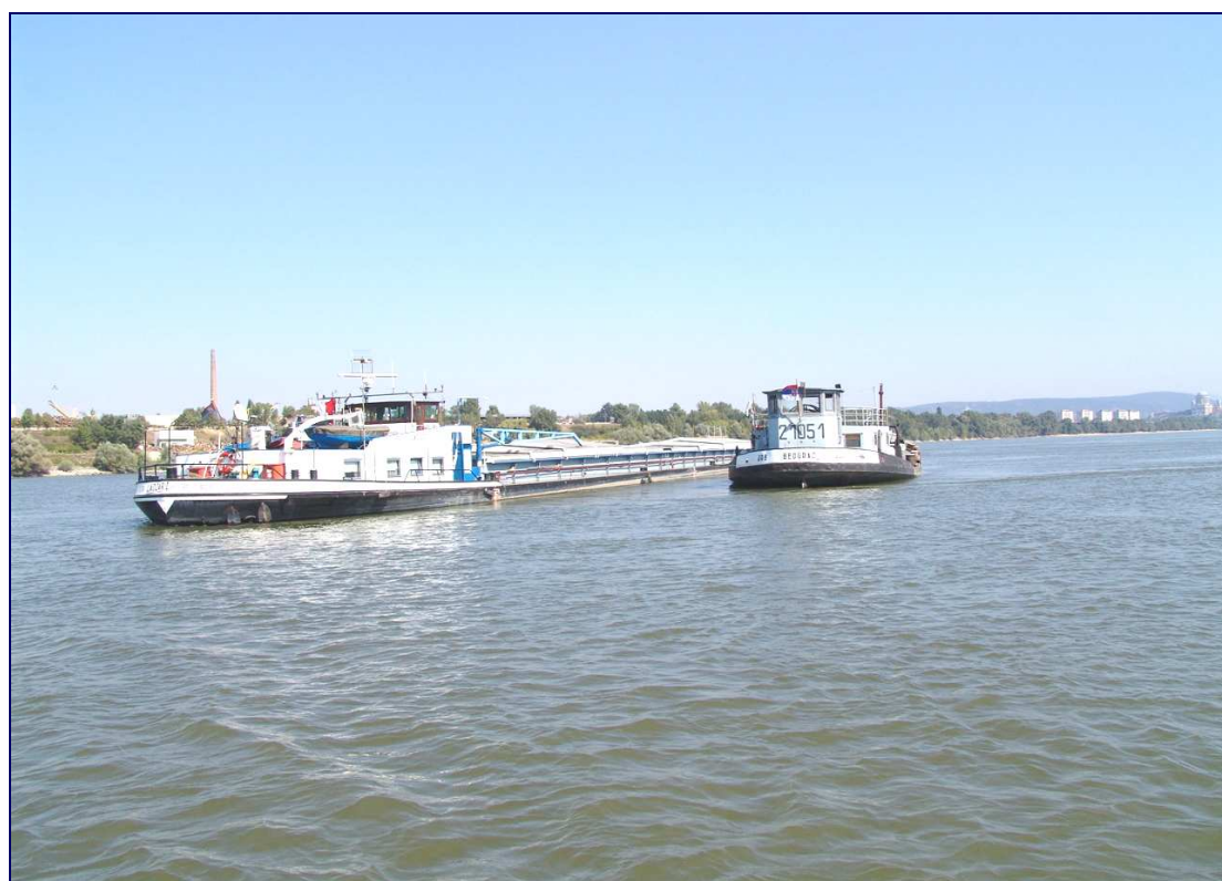
A zátonyon felakadt önjáró géphajó a hajó jobb oldalára csatolt uszályal, a képeken látható a vörös bója hiánya
