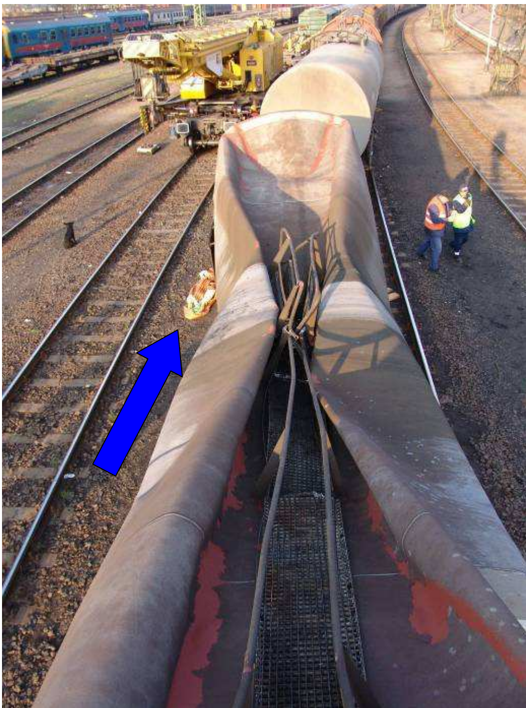
7. ábra: A 33 80 787 5872-3 pályaszámú kocsí összeroppant tartályteste
