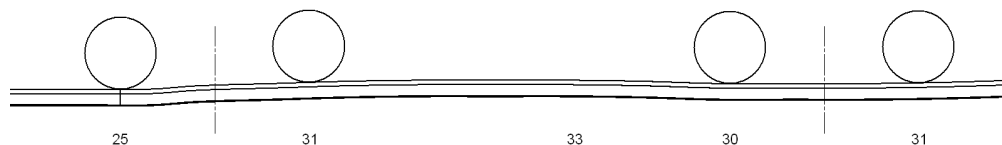
11. ábra: a mozdony kerekeinek közelítőleges helyzete a kisiklás kezdetén (az ábra 10x-es magassági torzítást tartalmaz)
