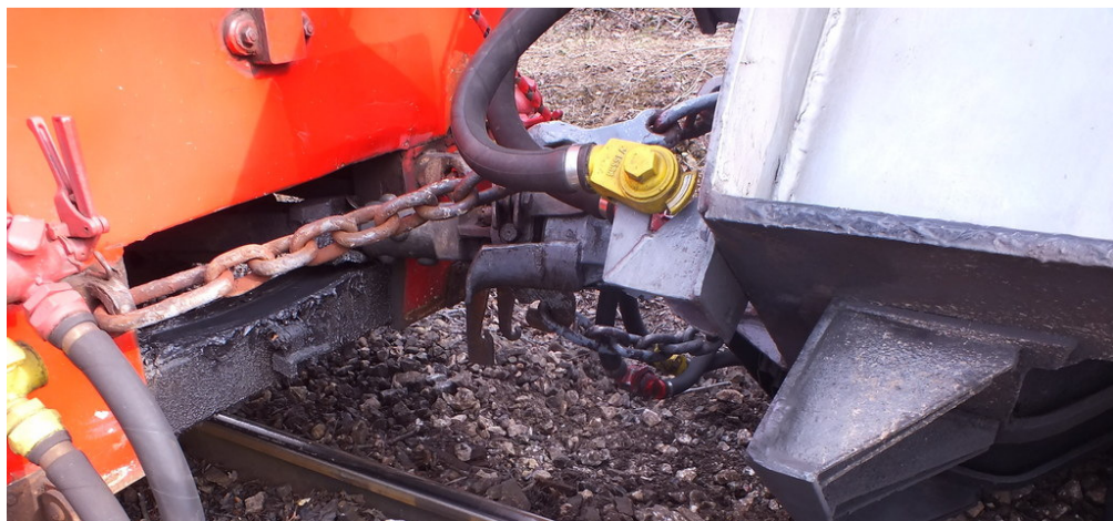
4. ábra: a mozdony és az első kocsi közti vonókészülék
