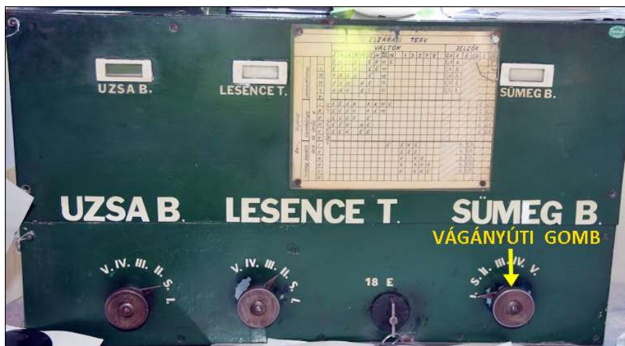
9. ábra: A forgalmi irodai berendezés
