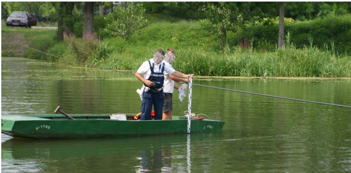
5. ábra: a komp kötelének távolsága a vízszinttől az ütközés helyén
