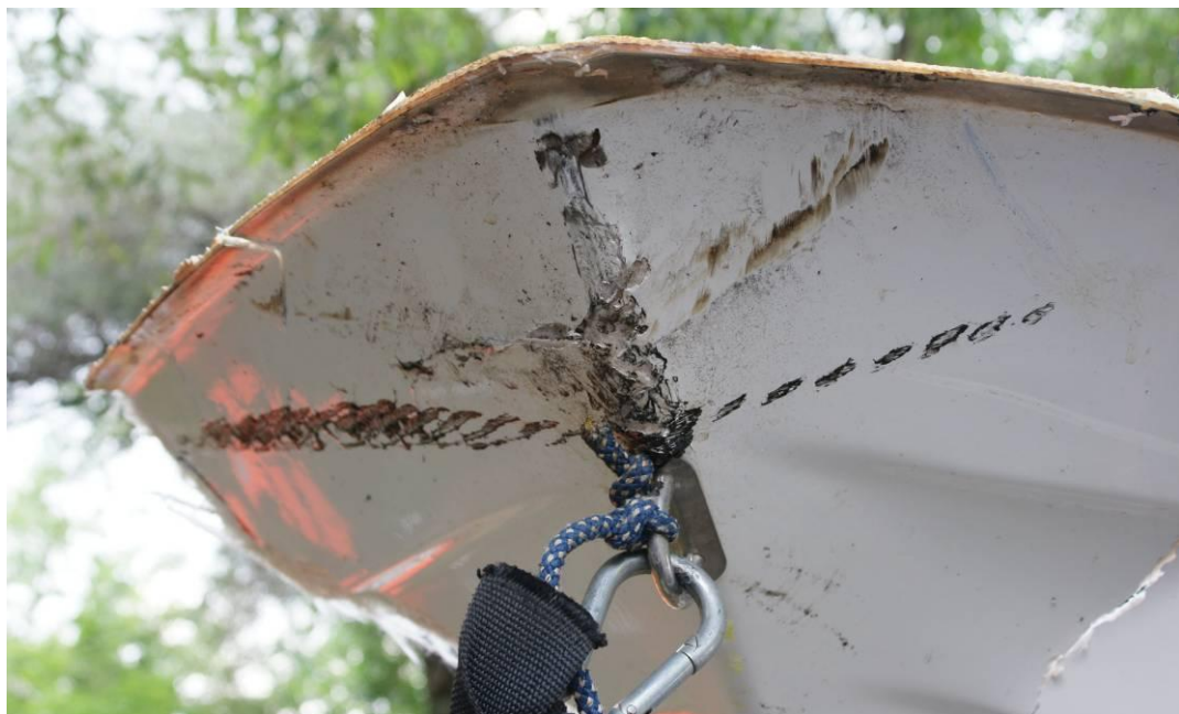
4. ábra: a komp vezetőkötélnek nyoma a kiséphajó orr részén
