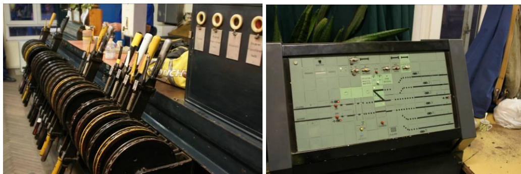
6. ábra: A III. sz. állítóközpont állítókészüléke és kezelőpultja
