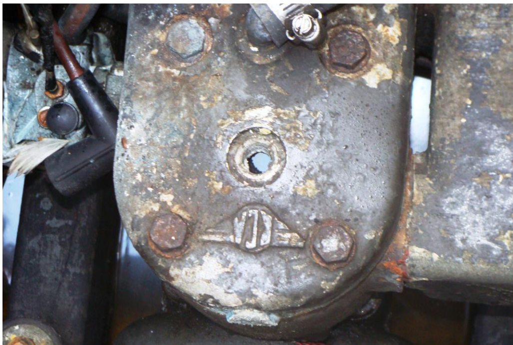
5. sz. ábra: A gyertya helye a hengerfejben, a hengerben az oltás után víz látható
