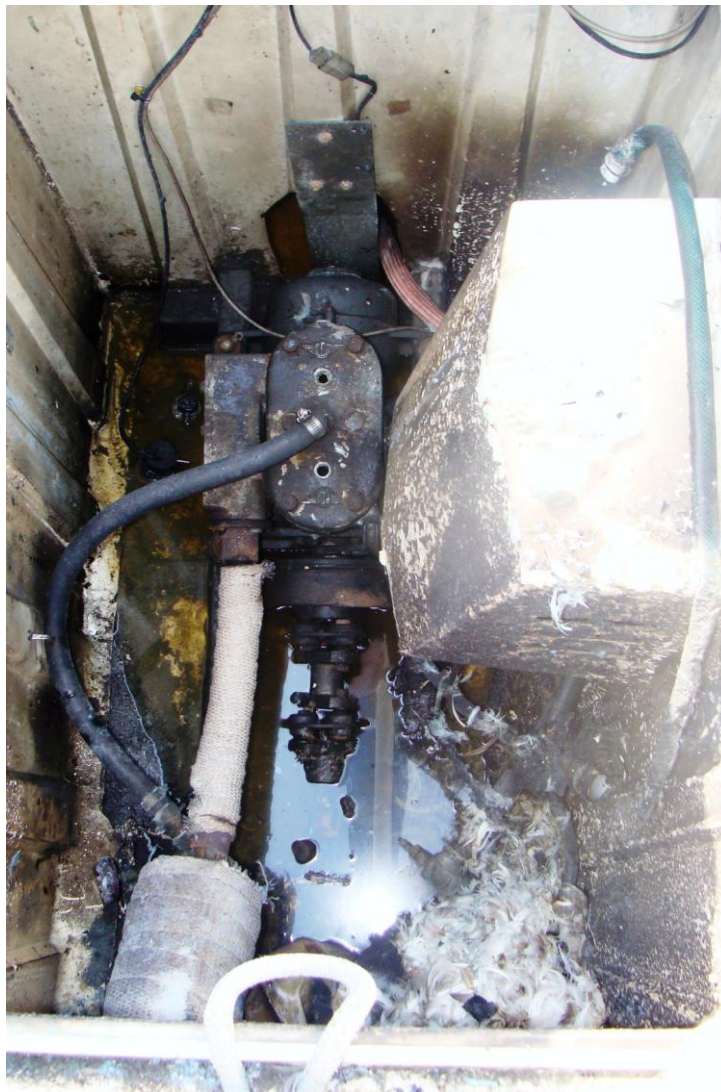
6. sz. ábra: A motortér a tüzeset és az oltás után
