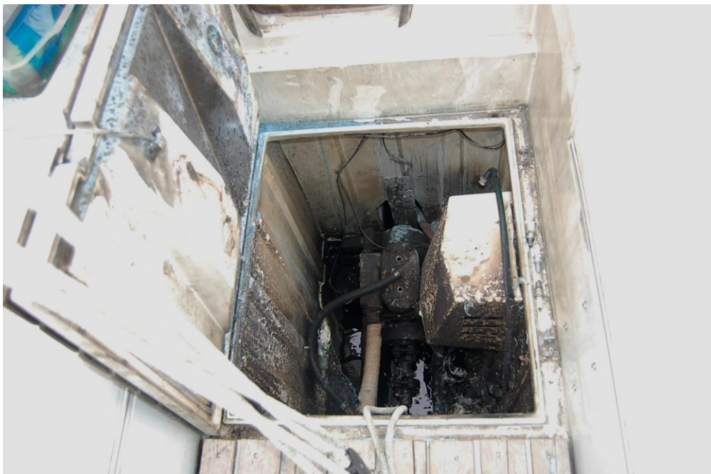
3. sz. ábra: A lepecsételt motortér felnyitása után, a tüzeset nyomai jól láthatóak
