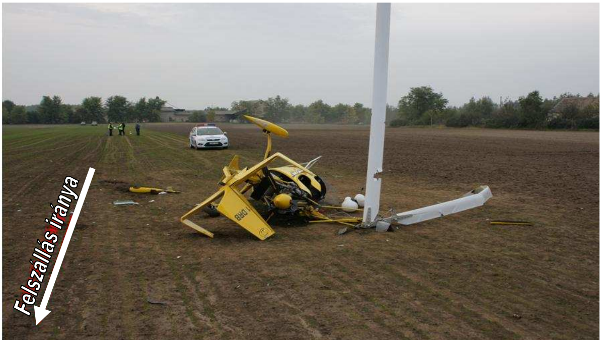
1. számú ábra. Az autogiró nyugalmi helyzete a felszálló irányhoz képest.
