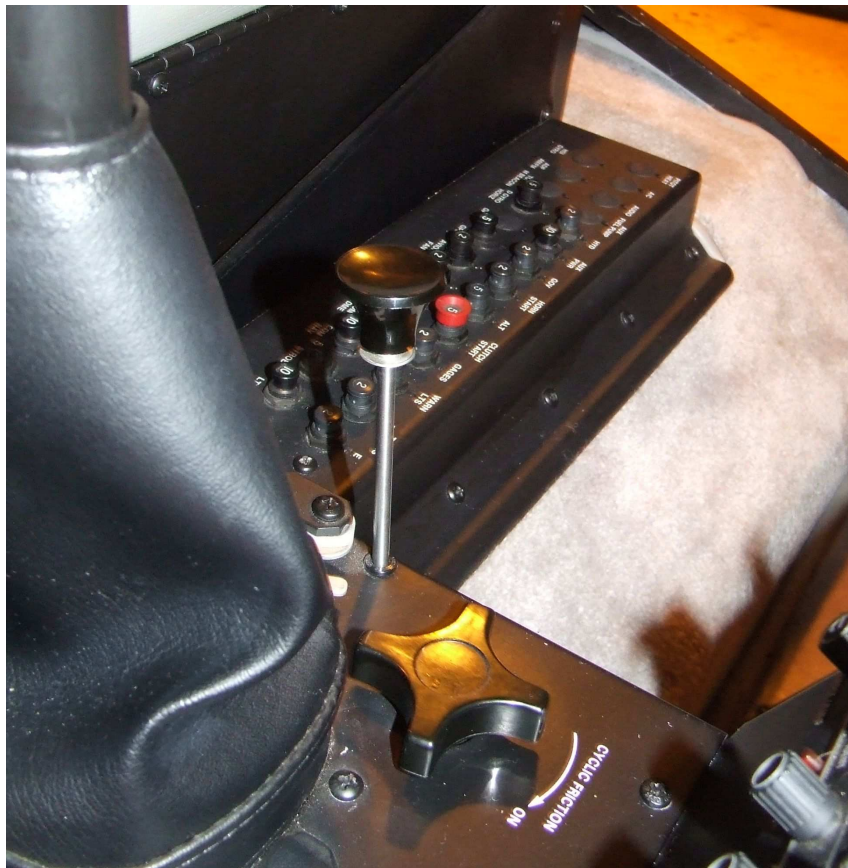
4. ábra: A porlasztófűtés vezérlőkar fűtés helyzetbe kapcsolva
