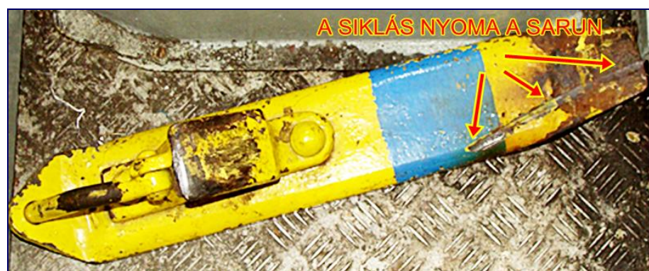
10. ábra: A siklást okozó rögzítősaru
