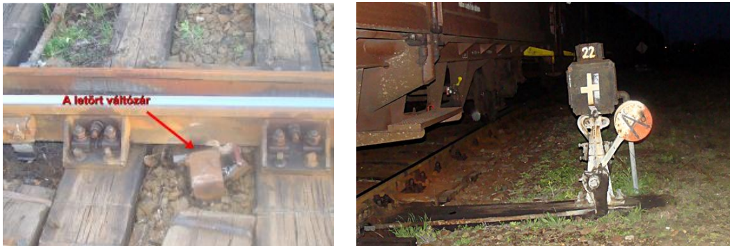
9. ábra: A letört váltózár és a váltójelző
