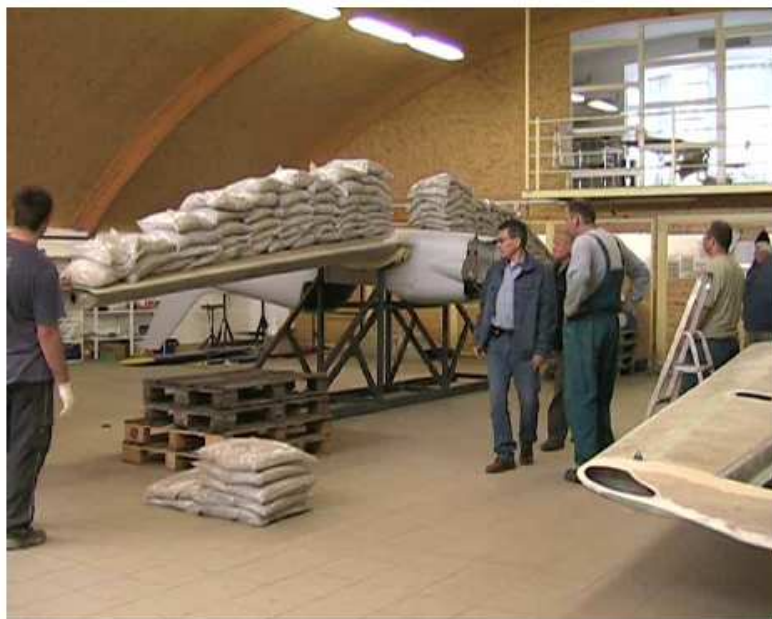
10 / b ábra – Az Mk II még festetlen szárnyának bevizsgálása 2006-ban a PLH jelenlétében
