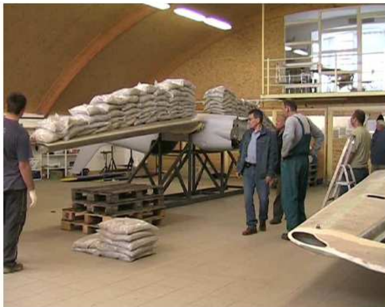
12-es számú ábra – Mk II törzs és szárny együttes vizsgálata
