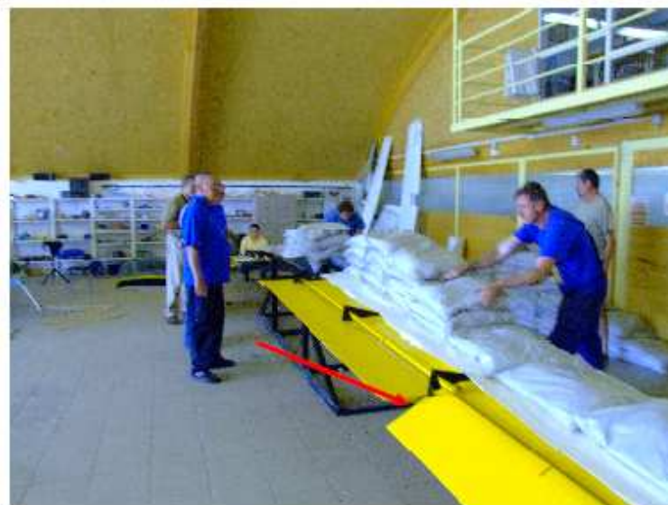
10 / a számú ábra – A szárny bevizsgálása mechanizációkkal a PLH jelenlétében
