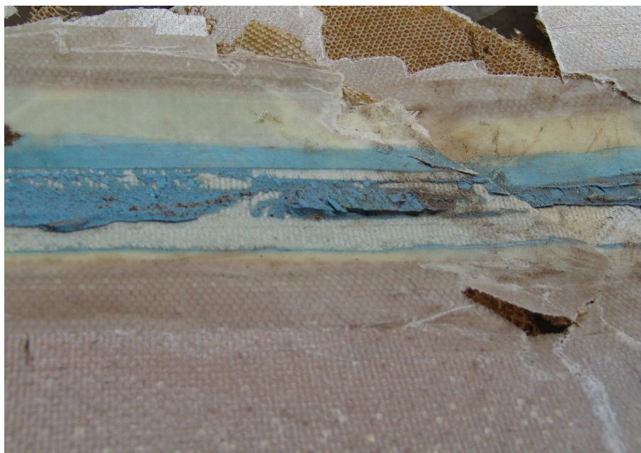
A szárnyhéj belső felülete a levált ragasztóként használt anyaggal (kék színű vastag réteg)
