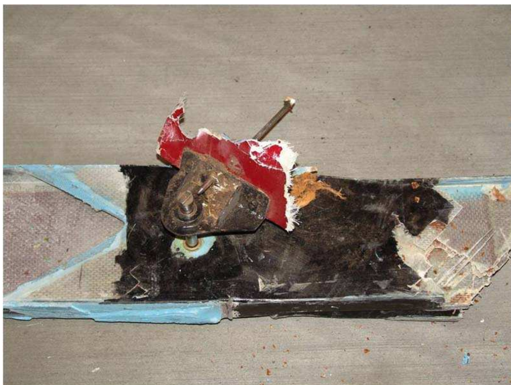
12. ábra: A főtartó csapszeg biztosítása
