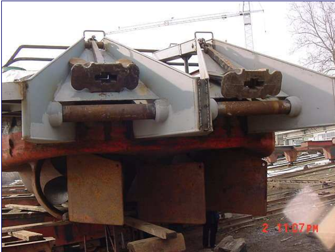
A Szombathely ms. farhorgonyai az átépítés után. A kormányrendszer változatlan
